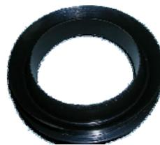
Рис. 5. Образец манжетного уплотнения для стендовых испытаний
