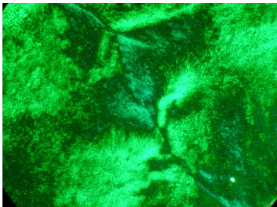
Рис. 3. Микрофотография текстуры термотропной мезофазы соединения IVa , T = 183,7\text{ }^{\circ}\text{C} (процесс нагрева), николи скрещены, \times 250
