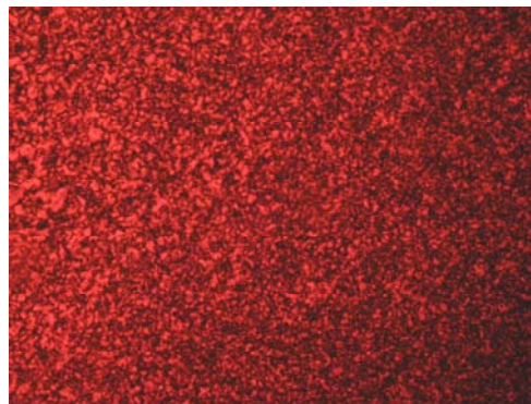
Рис. 3. Микрофотография застеклованного состояния текстуры термотропной мезофазы соединения III при охлаждении, T = 27,1\text{ }^{\circ}\text{C} , николи скрещены, \times 250
