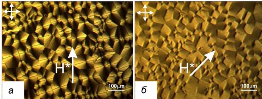
Рис. 1. Микрофотографии структуры 5ЦБ на подложке ПК, параллельно которой в процессе роста доменов прикладывалось магнитное поле  $H^*$ :
