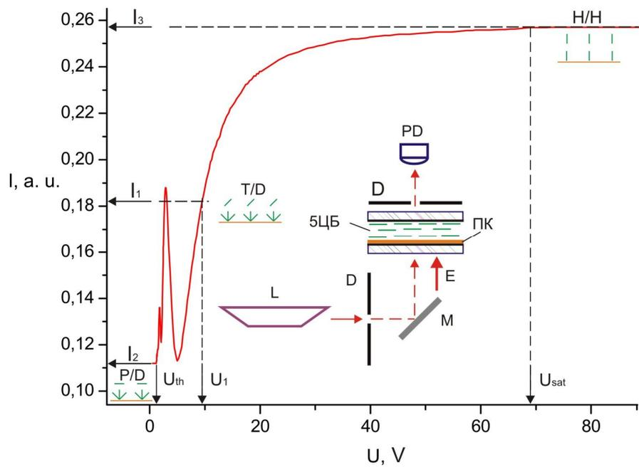
Рис. 4. Зависимость интенсивности света  $I$ , прошедшего через образец Б, от напряжения  $U$
