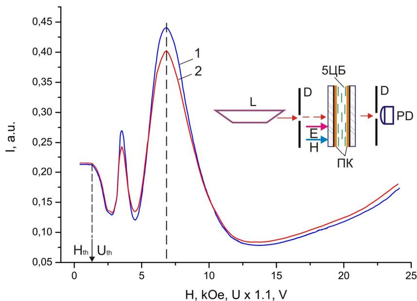
Рис. 6. Зависимости интенсивности света  $I$ , прошедшего через образец  $B$ , от магнитного поля  $H$  (кривая 1) и от напряжения  $U$  (кривая 2)
