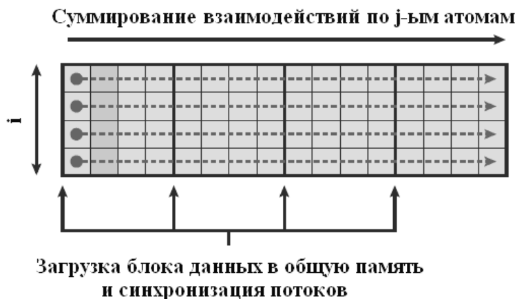
Рис. 5. Схема работы алгоритма блочного копирования данных
