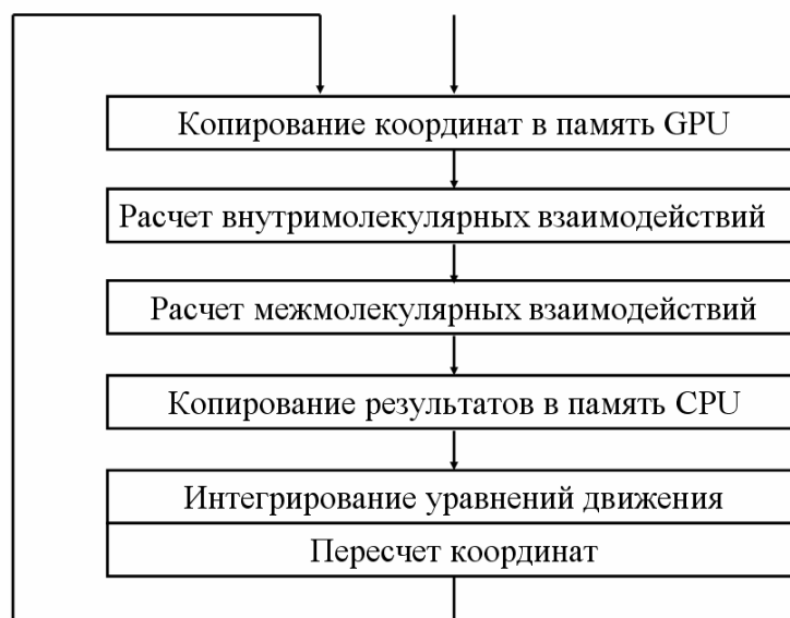
Рис. 3. Блок-схема вычислений по методу молекулярной динамики при использовании графических процессоров
