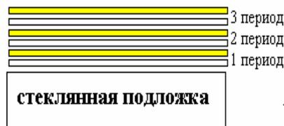
Рис. 2. Схема фотонной структуры из трех периодов. Неокрашенные и окрашенные области обозначают соответственно мультислой сополимера и красителя
