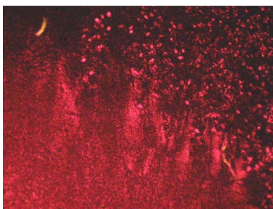
Рис. 5. Микрофотография текстуры трехфазного района контактного препарата соединения XV с толуолом (Mes + Iso + Cr). T = 22,0\text{ }^{\circ}\text{C} , николи скрещены, \times 250
