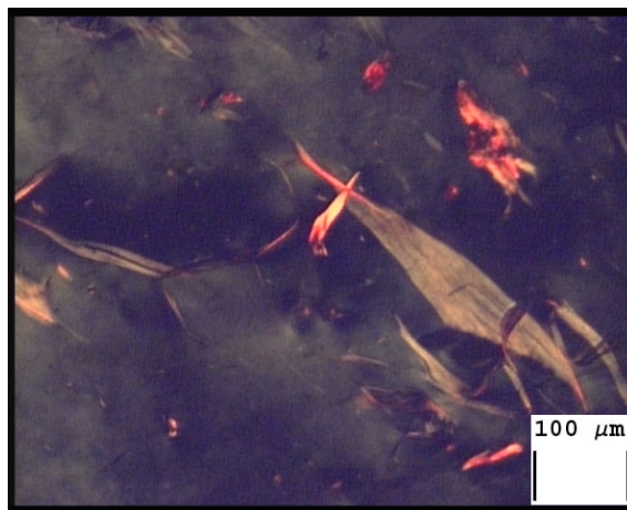
Рис. 6. Макроскопические агрегаты в образце с концентрацией 0,8 мас. % БП-4В в воде
