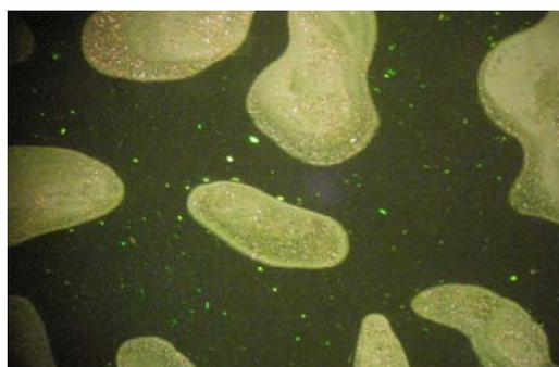
Рис. 10. Микрофотография текстуры соединения VIб, процесс нагрева, T = 290,6 °C, николи скрещены, x 250
