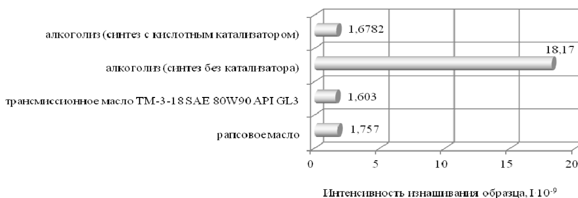
Рис. 5. Результаты определения интенсивности изнашивания неподвижного образца (шара) в присутствии полученных продуктов алкоголиза
