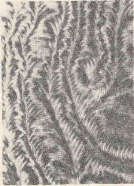
Рис. 3. Мгновенная фотография начала динамического рассеяния в жидкокристаллической смеси, увеличено в 300 раз
