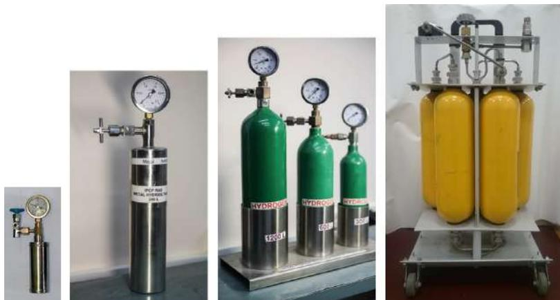
*Рис.* МГ аккумуляторы водорода, разработанные в Комплексе лабораторий водородного материаловедения ФИЦ ПХФ и МХ РАН
