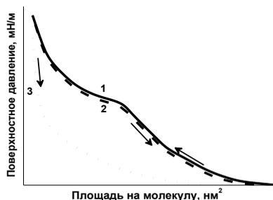
Рис. 3. Изотерма сжатия плавающего слоя: 1 – сжатие; 2 – декомпрессия аморфного слоя; 3 – декомпрессия структурированного слоя [4]
